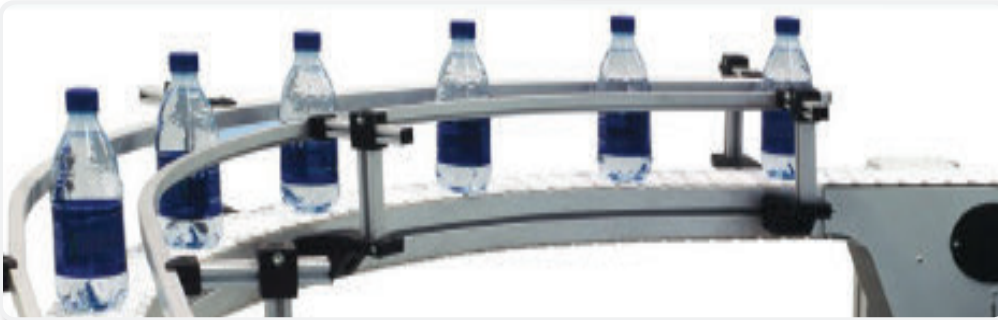
VF - Transfer Sistemi Uygulaması
